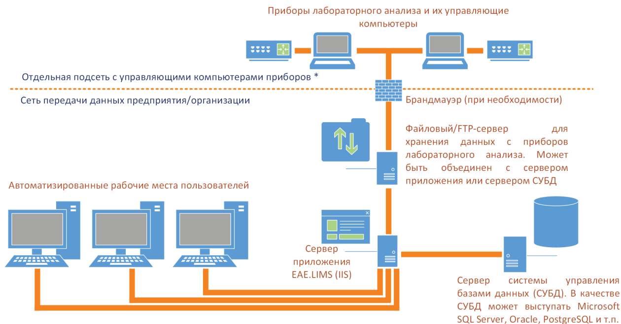
Рис. 1. Архитектура решения EAE.LIMS
